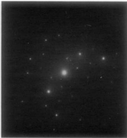
FIG. 5. Al_4SiC_4 : diffraction électronique Strate (001)*. 2\lambda L = 36,5 .
